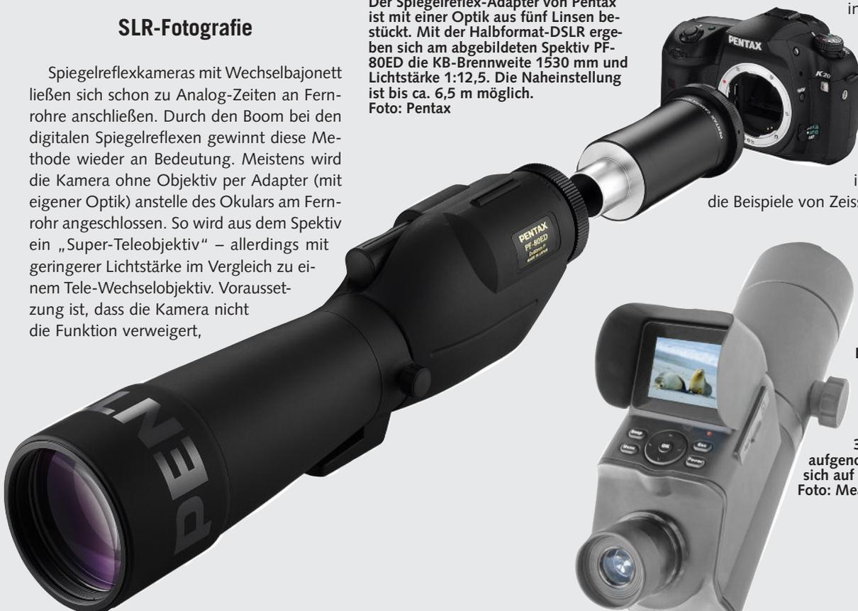
Das LCD-Spektiv 15x60 von Meade ist neben dem regulären Einblick auch mit einem LCD-Monitor ausgestattet. Die mit der integrierten 3-Megapixel-Kamera aufgenommenen Fotos lassen sich auf SD-Karten speichern.
