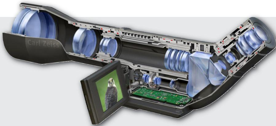
Kurz vor der Markteinführung: das Zeiss PhotoScope 85 T\* FL. Der Vergrößerungsbereich geht von 15 bis 45fach, wobei ein besonders weitwinkliges Sehfeld geboten wird. Über einen Strahlenteiler gelangt das Bild zum 7-Megapixel-CCD der eingebauten Digitalkamera. Eine spezielle Autofokus-Assist-Funktion unterstützt die manuelle Fokussierung. Angezeigt wird das Bild auf einem OLED-Monitor mit 7 cm Diagonale.
