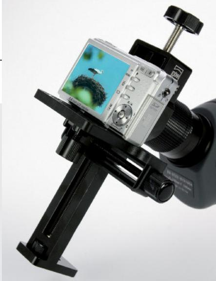
Die überwiegende Zahl der Kompaktkameras besitzt kein Filtergewinde. Sie lassen sich aber mittels Stativanschluss an Universal-Adaptoren montieren, die wiederum am Okular festgeklemmt werden. Foto: Dörr
