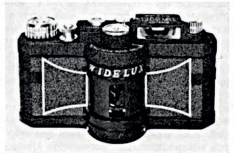
Bild 20. Teilpanorama-Kamera Panon Widelux mit sich drehendem Objektiv; Horizontalbildwinkel 140°, Aufnahmeformat 24 mm × 59 mm
